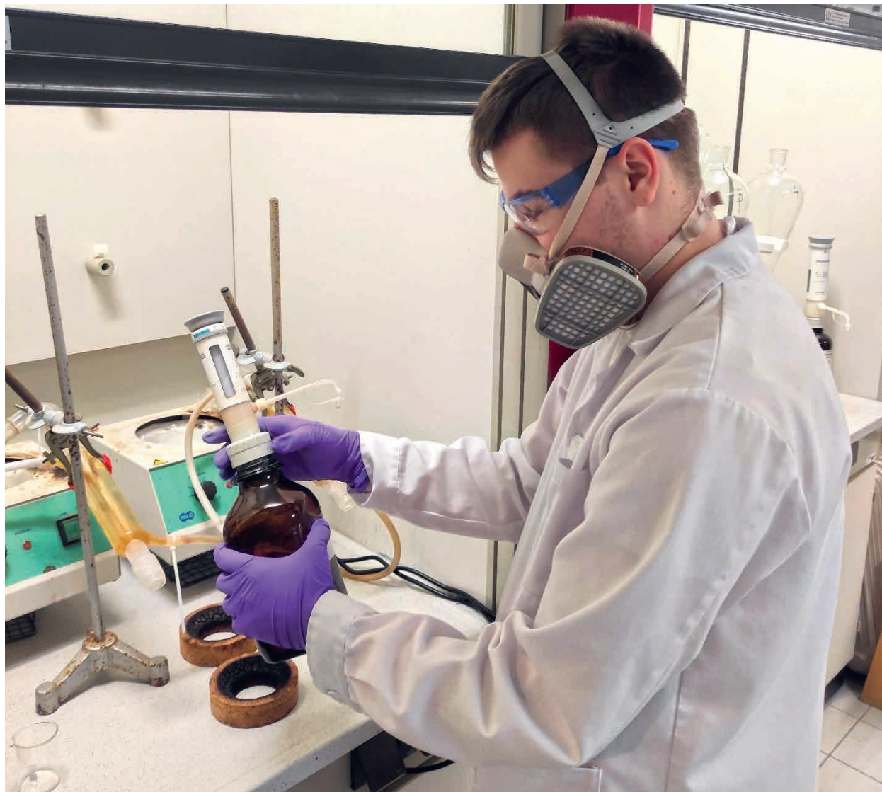
3. kép Oldatkészítés a vízkeménység érték meghatározásához
