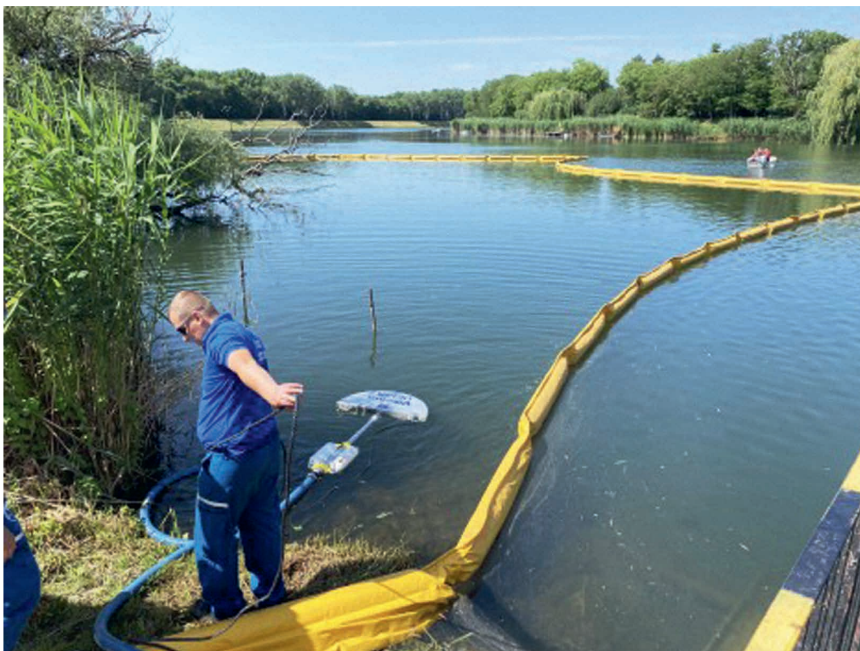
86. kép Alcsi-Holt-Tiszán feltételezett szénhidrogén szennyezés lehatárolása, és a VIKOMA DELTA SKIMMER sekély vízi olajförlöző gépet használata
