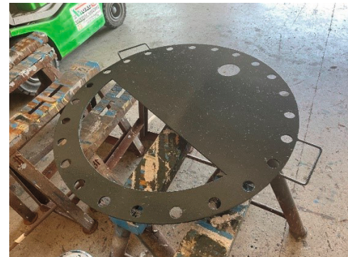
6. kép Tolózár átalakítása, speciálisan kivágott lemez beépítése
