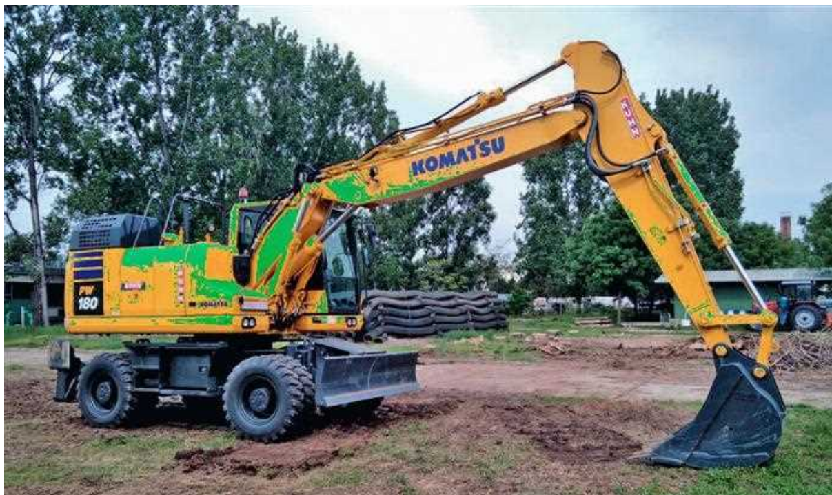
5. kép KOMATSU PW180-11E0 típusú gumikerekes kotrógép
