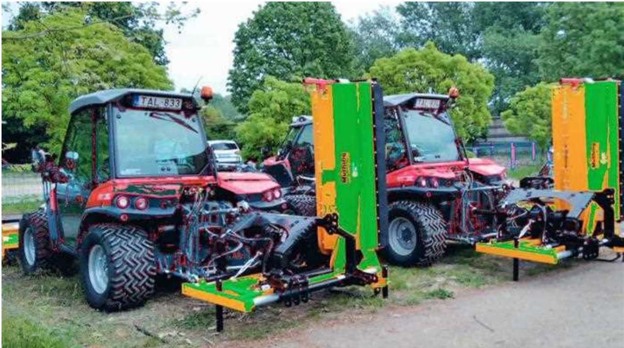
4. kép AEBI TT 281 típusú önjáró rézsűfenntartó gép
