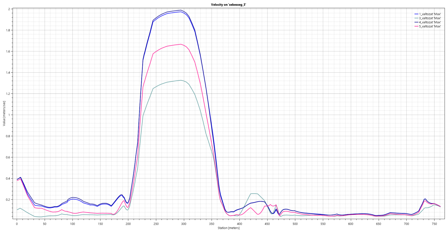
38. ábra Második eredmény nyomvonal mentén kialakult maximális sebességek (1. változat- sötétkék, 2. változat- világoszöld, 3. változat- kék, 4. változat- piros)
