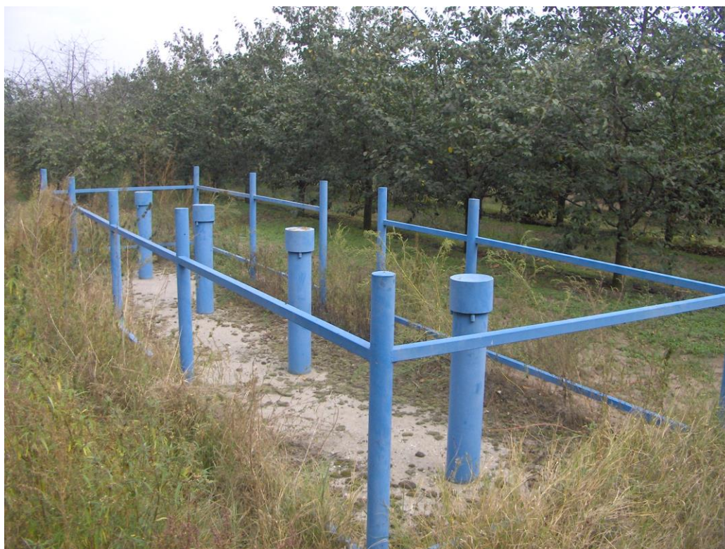
Talajvízszint figyelő kút
