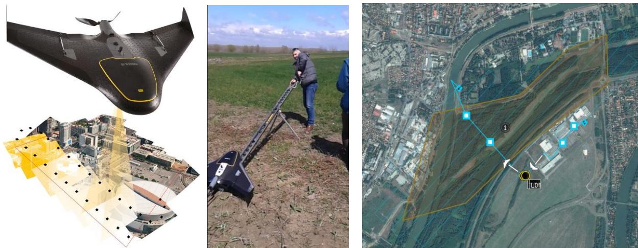
Az UX 5-ös repülő, a kilövő állvány és előfeszítés és a repülési tervkészítő program
