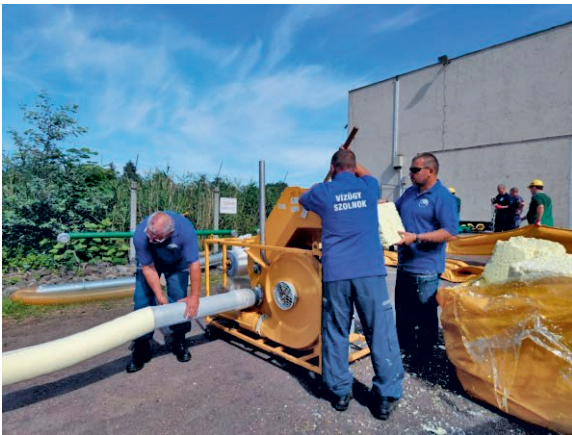
40. kép SANOL hurka készítése, SANOL örlemény kiszórása
