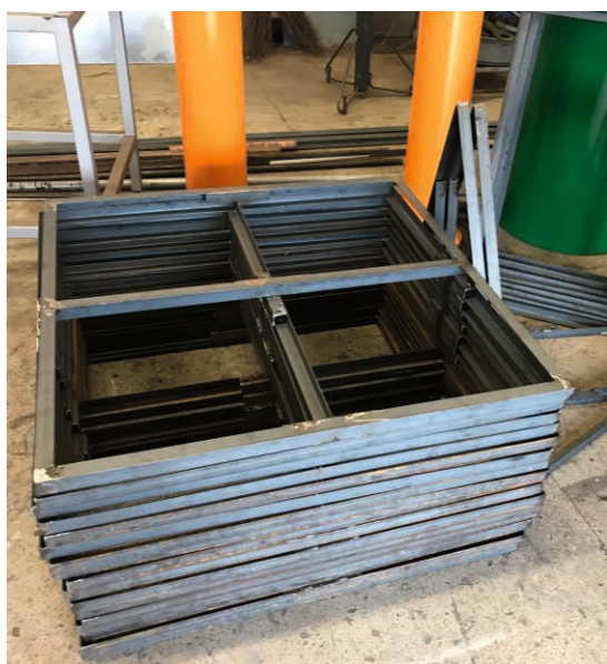
62. kép A Kiskörei szakaszmérnökség lakatos műhelyében készültek a tábla tartó keretek, melyeket egy környékbeli vállalkozás látott el korrózióvédelemmel tűzihorganyzásos technológiával
